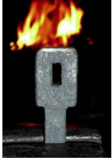
13. Nach mittelalterlichem Vorbild rekonstruierte Nocke in der Schmiede der Dombauhütte.
