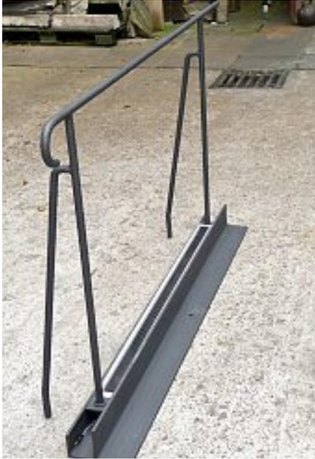
**17.** Modell einer Halterung für Geländer und Lampen in den Durchgängen des Südturmfundaments.
