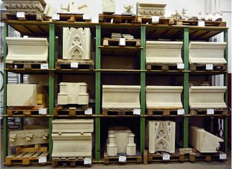
3. Fertig gestellte Werkstücke für die Südquerhausfassade in der Dombauhütte.
